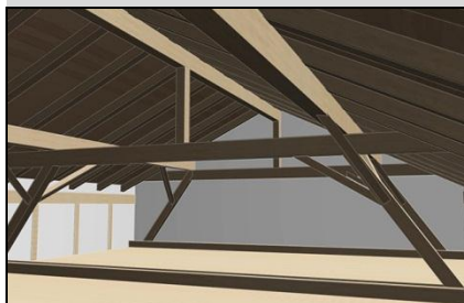
Tragkonstruktion: Stützen, Pfetten, Zangen, Sparren, Streben
