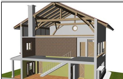
Wand- und Deckenaufbau: «einschalig» pro Wand bzw. Decke
